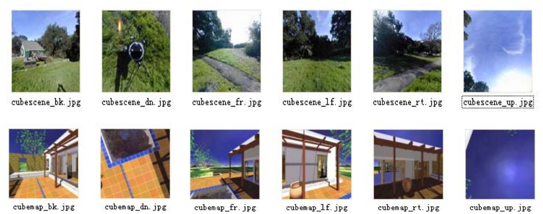
图 30 OGRE 图形引擎中提供的 2 组环境贴图
